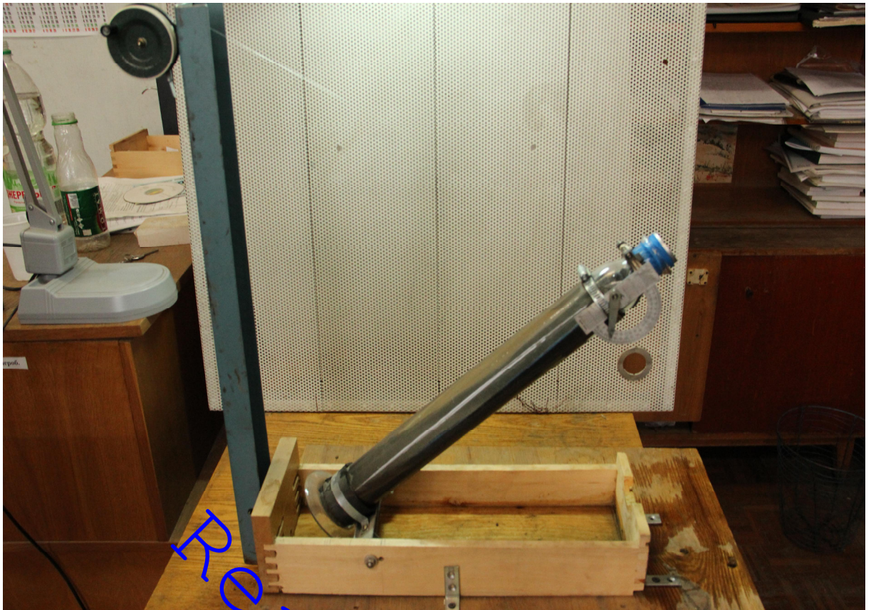
Рисунок 3 – Стенд для визначення коефіцієнта тертя частинок методом зісковзування досліджуваних твердих частинок в трубопроводі
