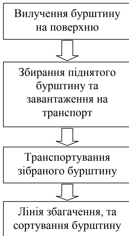
Рисунок 15 – Технологічна схема гідромеханічного вилучення бурштину
