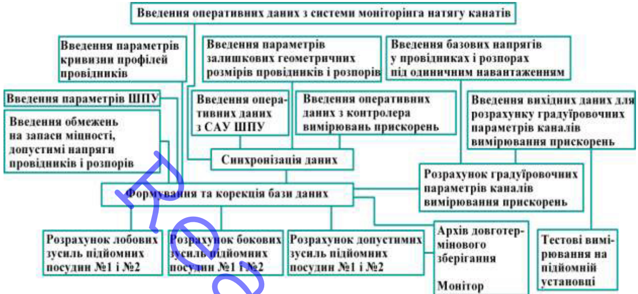
Рисунок 8 – Функціонально-структурна схема програмного забезпечення системи безперервного контролю плавності руху посудин
