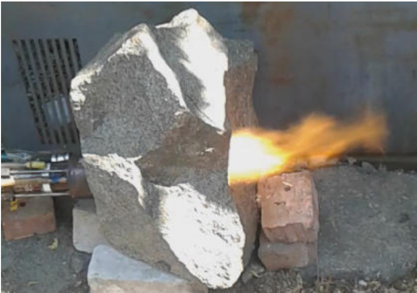
Рисунок 13 – Процес термічного розширення гірської породи за допомогою плазмової струмینی осьового плазмотрона
